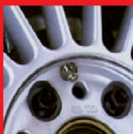
Ventil in die Radnabe integriert
